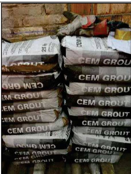
Material d'alta resistència per massissar la part inferior de les guies i els rails
