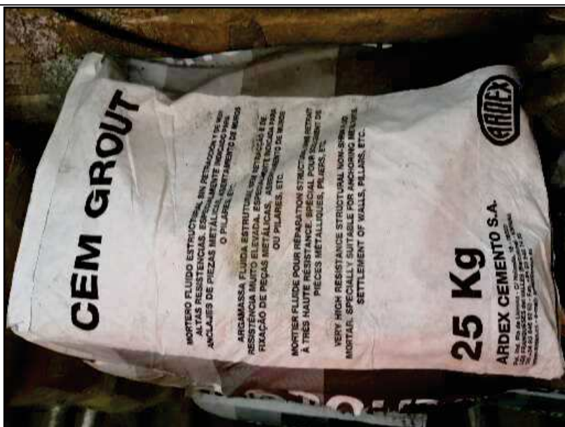
Material d'alta resistència per massissar la part inferior de les guies i els rails
