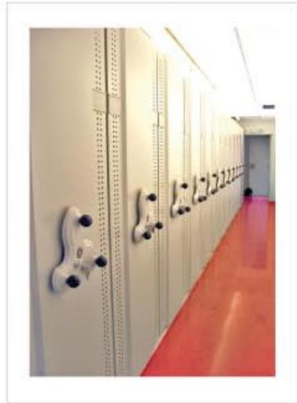
Instalación de armarios móviles compactos, con carenado frontal completo de una sola pieza en forma de omega, con perforaciones de 8 m/m. para la renovación de aire en el interior de los armarios. Los bastidores iniciales están equipados con chapas micro perforadas para evitar la entrada de luz y polvo al interior de la instalación.
